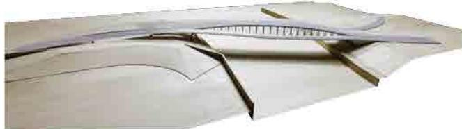
位于杨浦大桥旁的东岸·洋泾港桥又名“慧泓桥”，结构形式为钢结构异型桁架桥，主桥宽 10.75m，跨度 55m。设计利用高差分流骑行、跑步及漫步。整体造型轻盈，如彗星划过天际，跨洋泾港、指陆家嘴，清水一道为泓，结构如弓，隐喻浦东第一桥、蓄势待发，是为“慧泓桥”。
